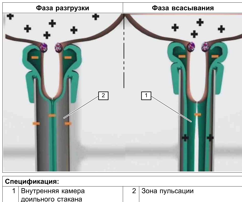
Сосок находится во внутренней камере доильного стакана. Здесь во время доения присутствует постоянный вакуум 32-40 кПа (в зависимости от потока молока).
